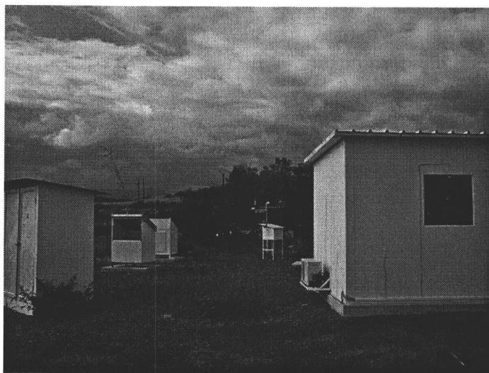
Figure 8 : Cellule expérimentale en environnement naturel pour l'étude du couplage système/enveloppe.
