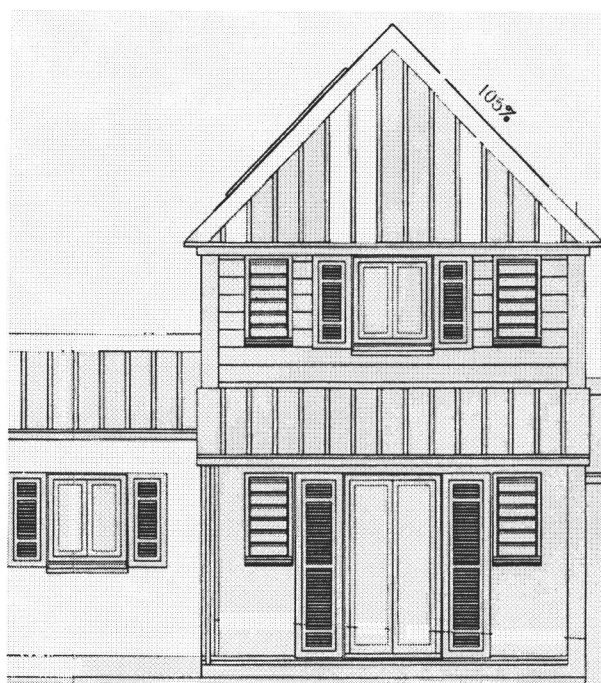
Fig. 10 : Apparition de nouvelles menuiseries (fenêtres + jalousies) sur les nouveaux projets pour augmenter la ventilation naturelle
