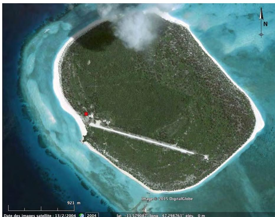
Figure 35 : Image satellite de l'île Grande Glorieuse, Google Earth. La localisation de la station sismique est représentée par le carré rouge. La station se situe à 600 m de la barrière de corail. Crédits Image DigitalGlobe.
