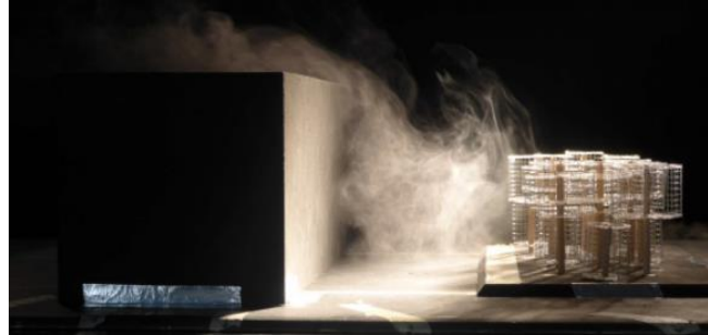
Figure 5 Essai en soufflerie pour détermination des coefficients de pression en façade en fonction d'un plot végétal. Incidence du vent 0°, végétation haute et basse à 12 m de distance.
