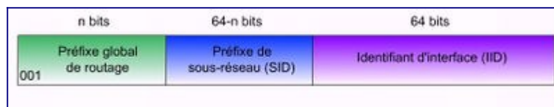
Figure 6 : Format général de l'adresse unicast globale.
