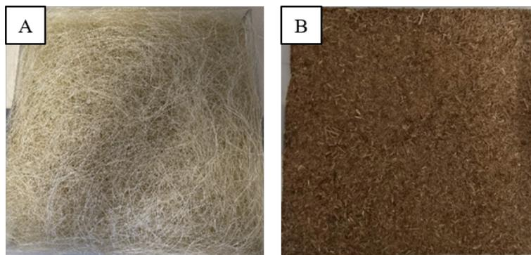
Figure 3 : Isolants en vrac à partir de fibres de choka (A) et de broyat de feuilles d'ananas (B)
