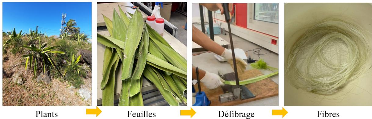
Figure 1 : Extraction manuelle des fibres de choka
