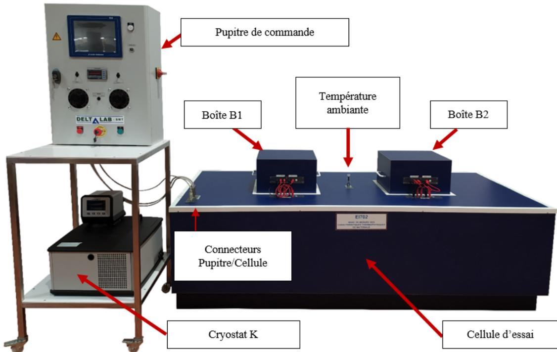
Figure 4 : Cellule de mesure de la conductivité
