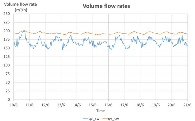
Figure 7 : Évolution des débits d'eau de mer et d'eau glacée
