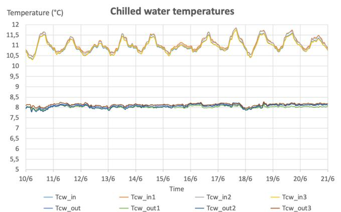
Figure 5 : Évolution des températures côté eau glacée
