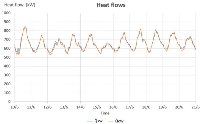
Figure 6 : Évolution des puissances thermiques primaire et secondaire
