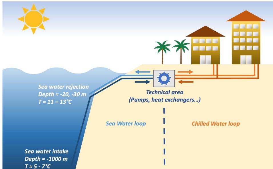
Figure 1 : Schéma du principe de fonctionnement du système SWAC
