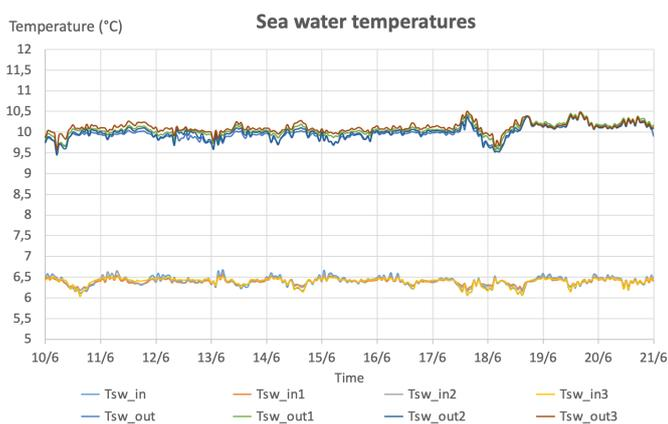
Figure 4 : Évolution des températures côté eau de mer
