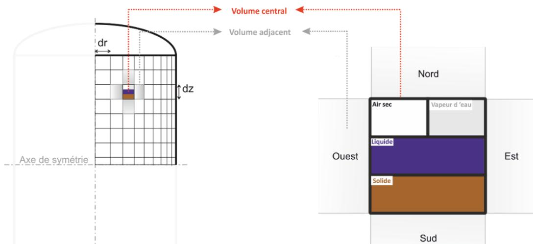
Figure 4 : Discretisation spatiale du domaine cylindrique (gauche) et composé de plusieurs VER (droite).
