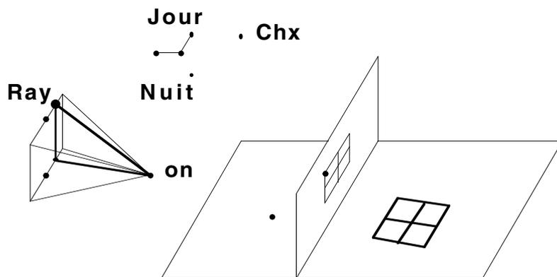
Sur le premier schéma, de jour, apparaît l'inclinaison de l'éclairage solaire, qui passe par le point *on*, modifiable dans deux directions : un premier point donne un angle d'inclinaison avec le sol, et le point *Ray* donne une incidence au rayon lumineux. De nuit, la construction du rayon lumineux disparaît pour laisser place à un réverbère :
