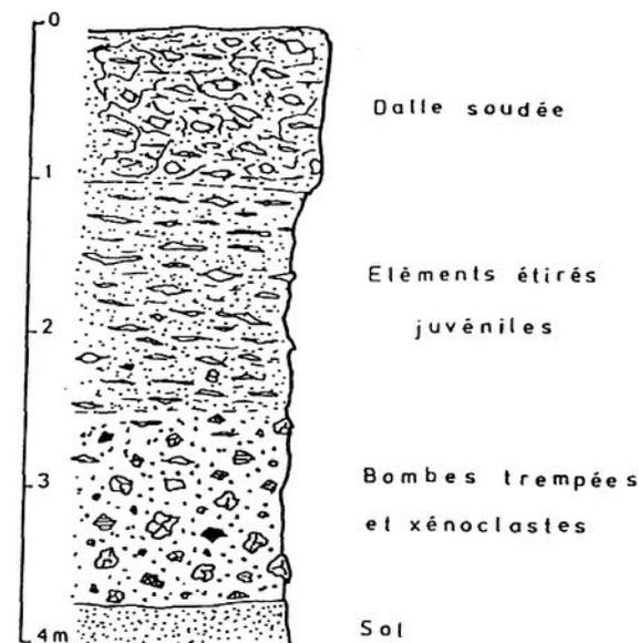
Fig. 4. - Passage de la formation à bombes trempées à la « dalle soudée ».
