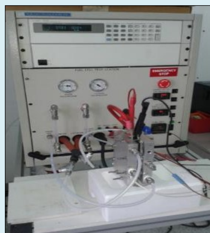
Banc de tests pour PEMFC pour des puissances jusqu'à 600 W
