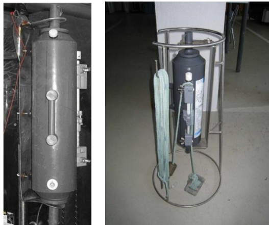
Photo 4 : Exemples de support de bouteille de prélèvement
